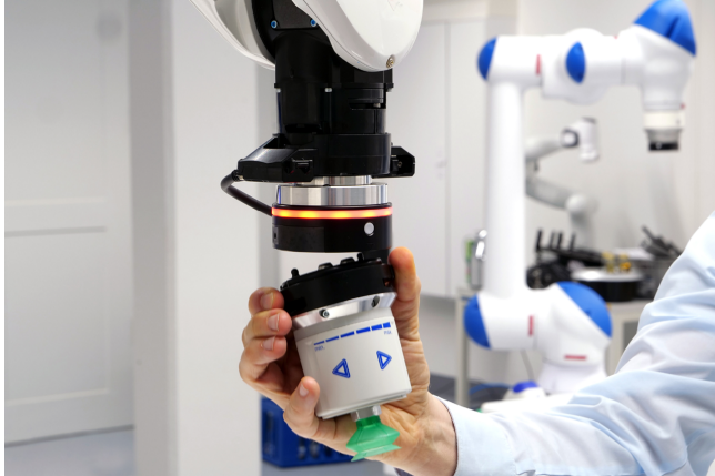
Быстросменный модуль RMQC при ручной замене захвата
